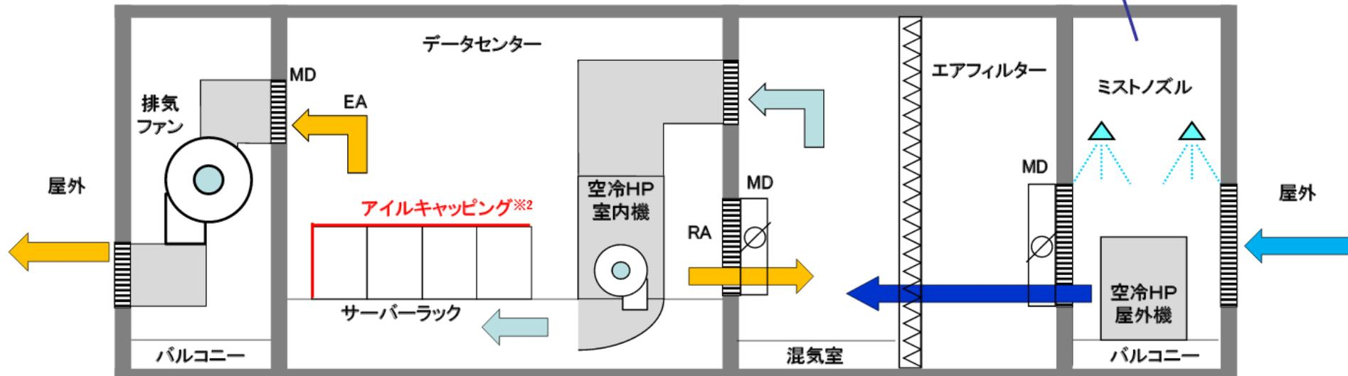
ミスト併用直接外気空冷システムイメージ(ミスト噴霧時)<sup>※1</sup>
